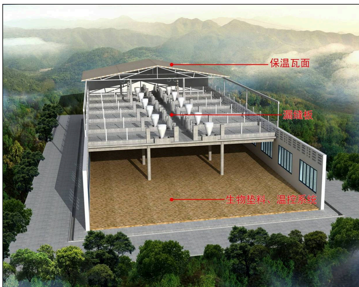
图 4.4-2 高床发酵型养猪模式猪舍结构图
