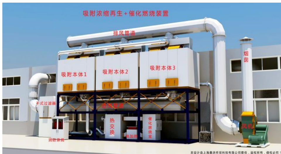
图 4-7 “活性炭固定床吸附+CO 装置” 示意图
