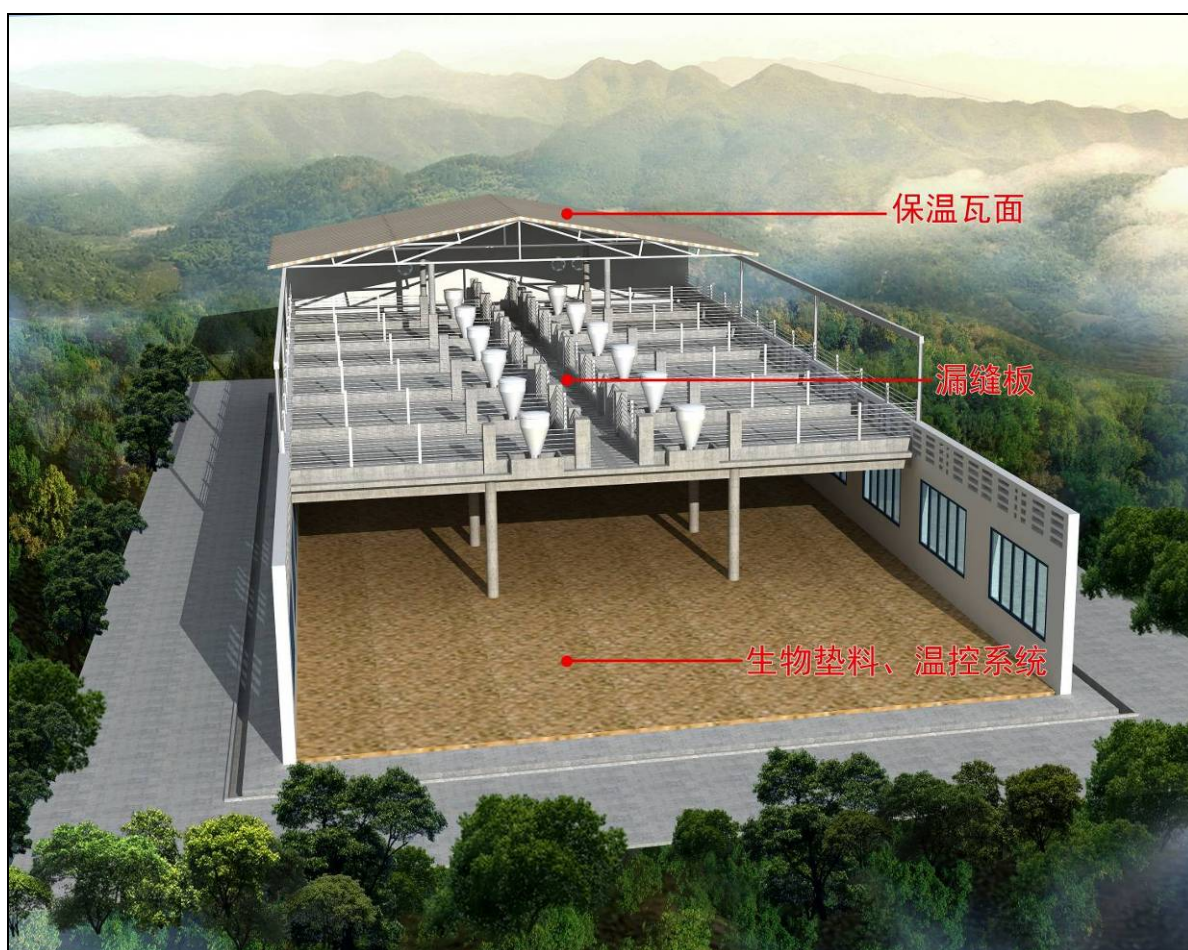
图 3.6-2 高床发酵型养猪模式猪舍结构图
