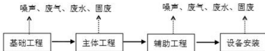
图 5-1 项目施工期建设流程及产污节点图
