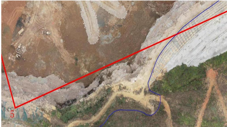
图4-1 露天采场外围修建的截水沟影像图（局部）
